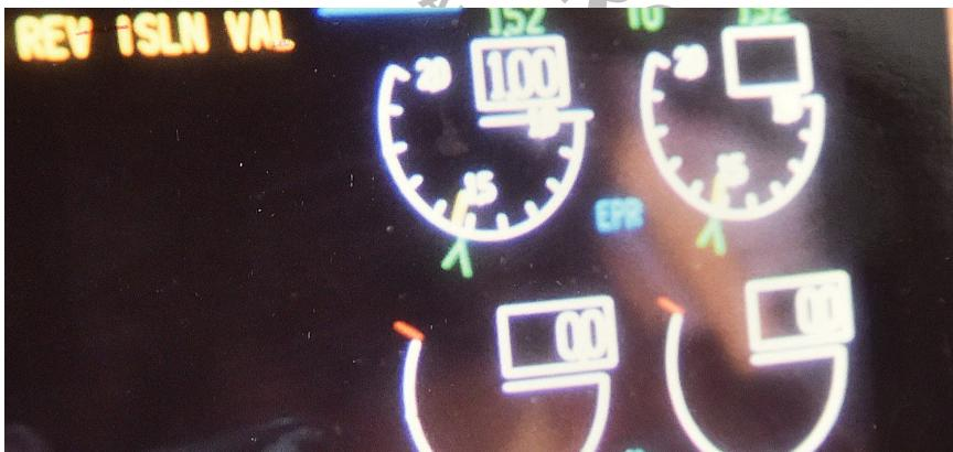
*Die in gelber Schrift gehaltene „REV ISLN VAL“-Meldung (links oben am Bildrand) auf dem oberen der beiden EICAS-Monitore in der Mitte zwischen den Piloten im Cockpit einer Boeing 767 der Lauda Air. Diese Meldung wurde nach dem Crash auf dem Boden nachgestellt.*
